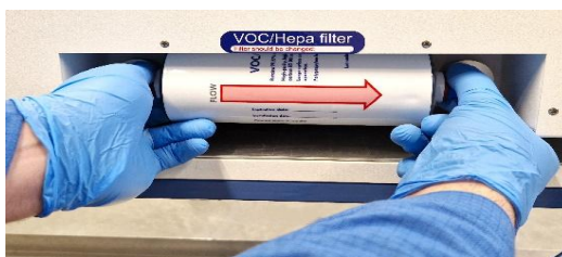
Εικόνα 12.2 Διαδικασία εισαγωγής και αφαίρεσης φίλτρου VOC/HEPA
