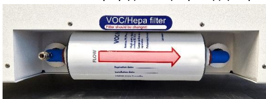
Εικόνα 12.3 Σωστά τοποθετημένο φίλτρο VOC/HEPA
